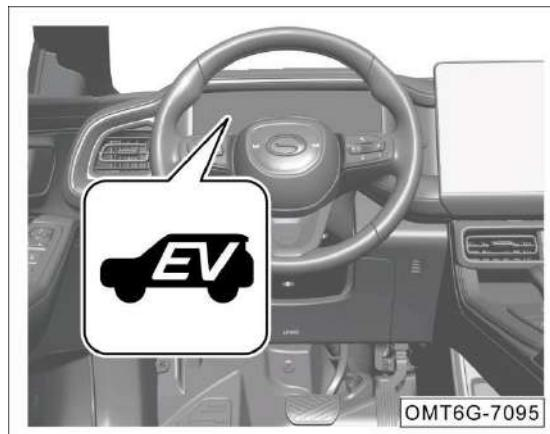
La luz indicadora de EV se enciende únicamente cuando el vehículo es impulsado por el motor de tracción o cuando el motor está apagado.
