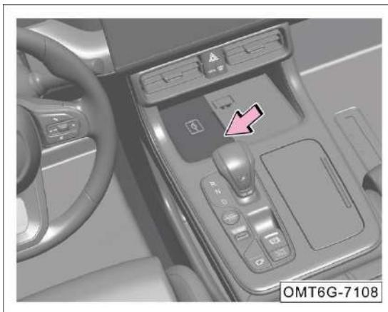
El área de carga inalámbrica efectiva se encuentra en la ranura de almacenamiento frente a la palanca de cambios. Al cargar, alinee la bobina de carga del teléfono móvil con el logotipo "Qi" para garantizar una carga normal del teléfono móvil.
