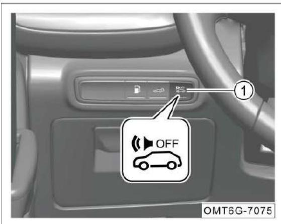
Presione el botón de encendido/apagado del sistema de aviso sonoro para peatones ①, la luz indicadora del interruptor se encenderá, en este momento el sistema de aviso sonoro para peatones estará apagado y el sistema no emitirá sonido.
