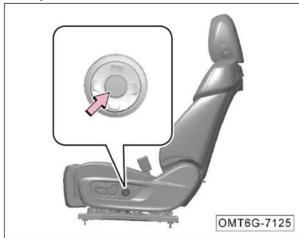
Cambie la alimentación del vehículo completo a la posición "ON" y presione brevemente el botón central del ajuste lumbar para activar la función de masaje del asiento. Presione nuevamente para apagar la función de masaje del asiento.
