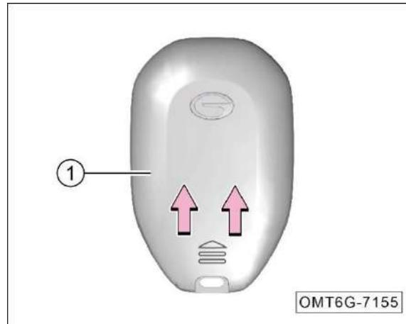
1. Tome la llave y empuje firmemente la tapa trasera ① con la mano en la dirección de la -flecha-. Retire la tapa trasera ① después de escuchar un "clic".
