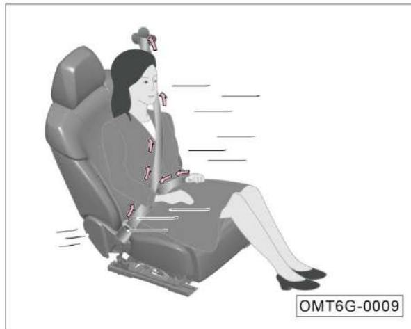
El dispositivo limitador de fuerza de pretensado del cinturón de seguridad puede reducir la presión del cinturón de seguridad sobre el pecho del conductor y los pasajeros y mejorar el rendimiento de la protección.
