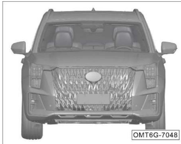
El parabrisas delantero utiliza vidrio laminado verde insonorizado y resistente a la dispersión, lo cual puede reducir efectivamente la gravedad de las lesiones en caso de accidente.
