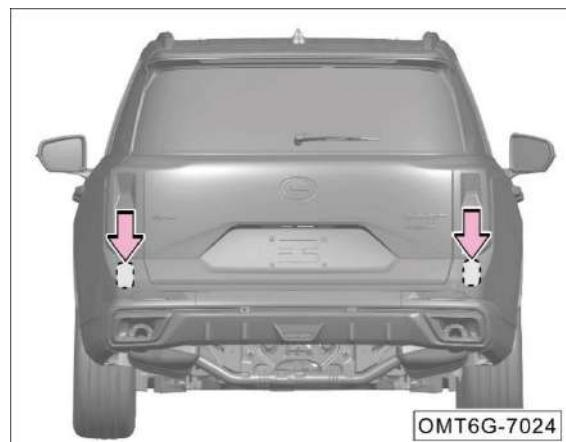
El sensor de radar del sistema de monitorizar el punto ciego está instalado como se muestra en la figura anterior.
