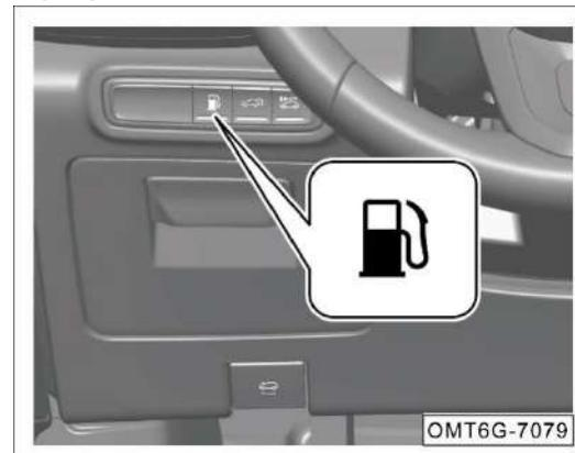
1. Mantenga presionado el botón de apertura de la tapa del tanque de combustible, y la tapa se abrirá hacia afuera.
