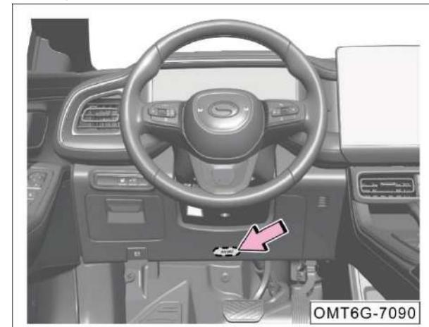
El airbag de rodilla para el conductor está instalado en el interior del panel de instrumentos (parte sombreada con líneas punteadas), y "AIRBAG" es el símbolo del airbag.
