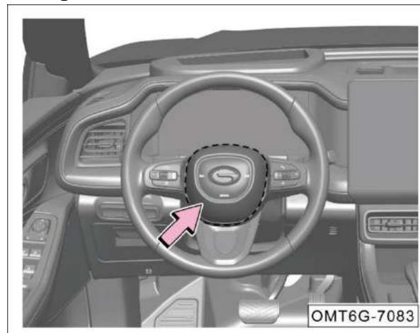
El airbag frontal del conductor está instalado dentro del volante (parte sombreada con líneas discontinuas), "AIRBAG" es el símbolo del airbag.
