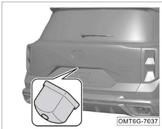
La cámara de visión trasera está montada al lado de la luz de matrícula.
