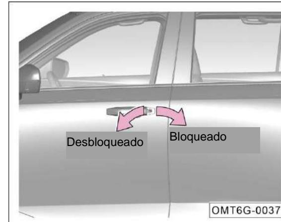
3. Inserte la llave mecánica de emergencia en el orificio del bloqueo de puertas del lado de conductor.
