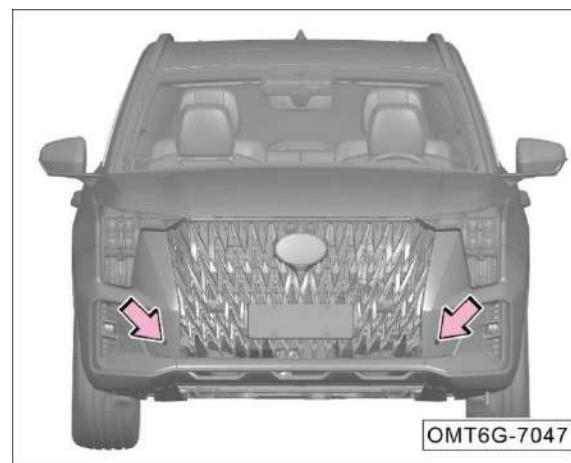
El sensor de radar ultrasónico delantero está instalado en la cubierta del parachoques delantero.
