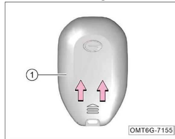
1. Empuje con fuerza la tapa trasera ① en la dirección de la -flecha- hasta escuchar un clic, luego retire la tapa trasera ①.
