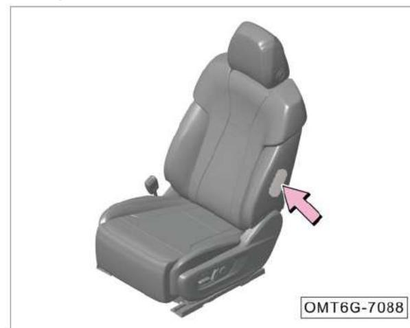
El airbag lateral delantero está instalado en el asiento del conductor y en el respaldo del asiento de los pasajeros delanteros hacia el interior de la puerta (sombrado por líneas discontinuas), y "AIRBAG" es el logotipo del airbag.
