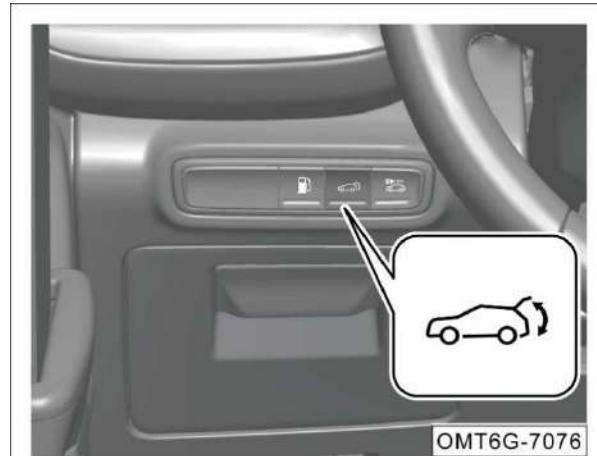
Mantenga presionado el botón del portón trasero en el panel de instrumentos, el portón trasero se abrirá automáticamente. Durante la apertura del portón trasero, presione brevemente este botón para pausar la apertura.
