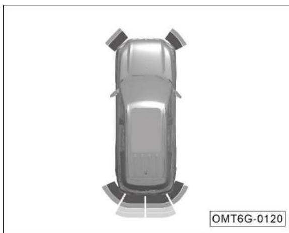
El icono indicador dinámico que aparece en el lado izquierdo de la pantalla indica la distancia a los obstáculos delante y detrás del vehículo actual. En la ilustración, los colores de las franjas del radar del vehículo son rojo, naranja, amarillo y verde desde el interior hacia el exterior. Cuando el obstáculo se acerca al vehículo, las líneas de color cambiarán gradualmente de la capa más exterior a la capa interior.
