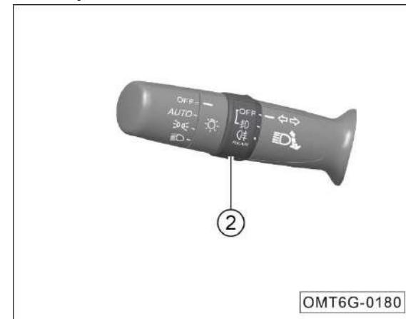
Cuando la alimentación del vehículo completo está en posición "ON", y la luz de posición o la luz de cruce encendidas, gire el interruptor de la luz antiniebla ② para controlar el encendido o apagado de la luz antiniebla delantera ⚡ y trasera ⚡.
