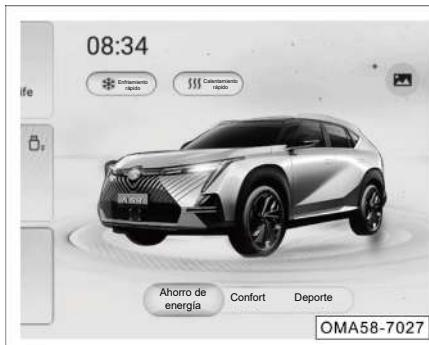
2. Con la alimentación del vehículo en posición "ON", seleccione para cambiar el modo de conducción a través del área de escena inteligente de la interfaz principal del sistema de audio.
