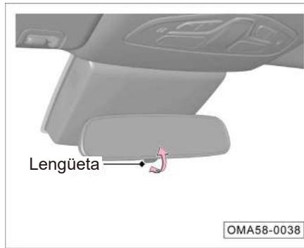
El ajuste manual del espejo retrovisor interior puede reducir el reflejo de la parte trasera, y hacer que la visión trasera esté en el mejor estado de observación.
