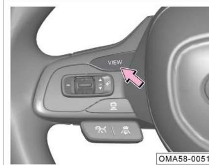
Con la alimentación del vehículo en la posición "ON", presione brevemente el botón "VIEW" en el lado izquierdo del volante para cambiar el tema del instrumento.
