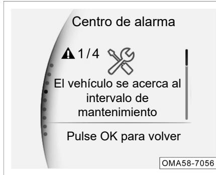
El centro de alarma generalmente muestra el estado actual del vehículo con información de texto o imagen, y el conductor siempre debe prestar atención a si hay alguna información de alarma.
