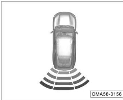
El icono esquemático dinámico que aparece en la pantalla indica la distancia entre el vehículo actual y el obstáculo. La capa más externa del vehículo en la imagen es una línea verde, y gradualmente se convierte en una línea amarilla, una línea naranja y una línea roja hacia adentro. Cuando el obstáculo se acerca al vehículo, la línea de color cambiará gradualmente de la capa más externa a la capa interna.
