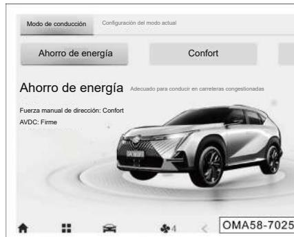
3. Con la alimentación del vehículo en posición "ON", seleccione para cambiar el modo de conducción a través del menú de la aplicación del sistema de audio "Modo de conducción".
