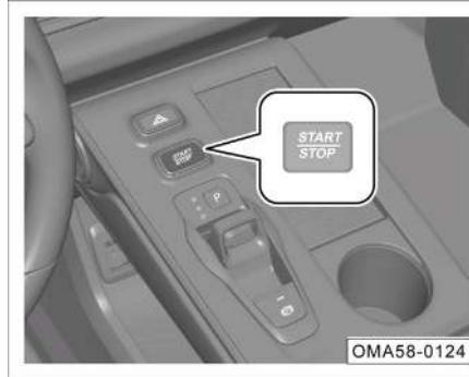
Se puede operar el interruptor de arranque (el botón STAR T STOP) solo cuando se detecta la llave de control a distancia inteligente dentro del vehículo.
