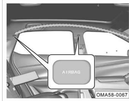
El airbag lateral de tipo de cortina está montado en el interior de la parte izquierda y derecha del techo (parte sombreada por línea de puntos), y "AIRBAG" es el símbolo del airbag.
